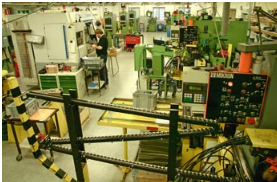
Automathallen. Efter den stora nyinvesteringen i fem kuggautomater av märket Mikron A33-2.
